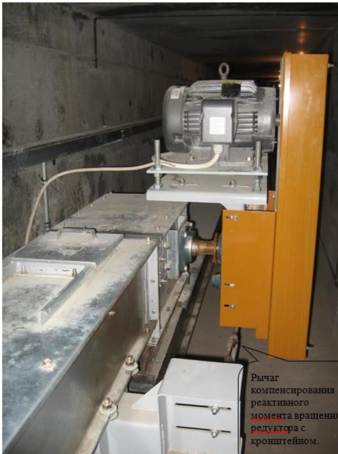
Рис.4. Приводная секция с двигателем
