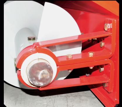
Усиленная балка для кронштейнов.
