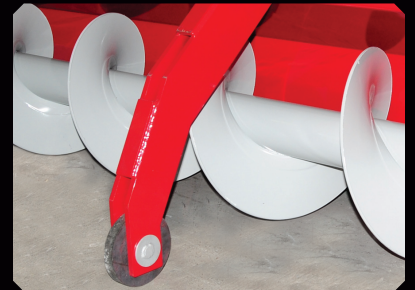
Новая конструкция передней части стойки вращающихся дисков.
