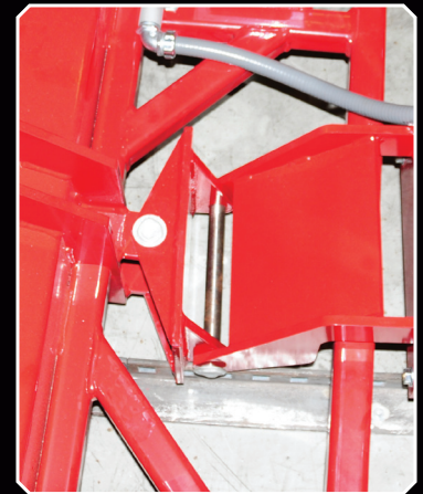
Конструкция оси вращения соединяется с редуктором, прикрепленным к шнеку
